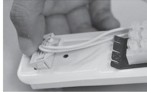
**Avvitare il pressacavo in dotazione, ed inserire il cavo di alimentazione, effettuare il collegamento di fase, neutro e messa a terra con la linea di alimentazione e richiudere la base, ruotando nuovamente gli attacchi di sicurezza.**
